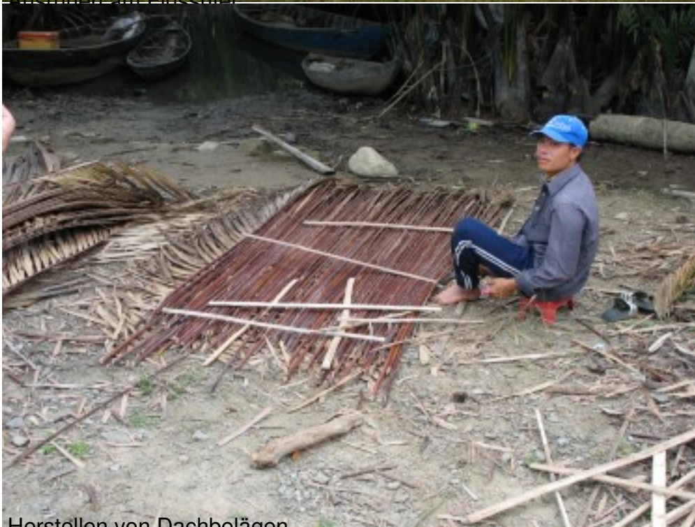
Herstellen von Dachbelägen
